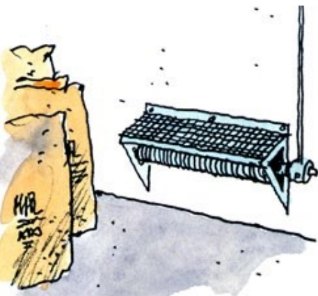
Elradiatorer med övertäckningsskydd.
